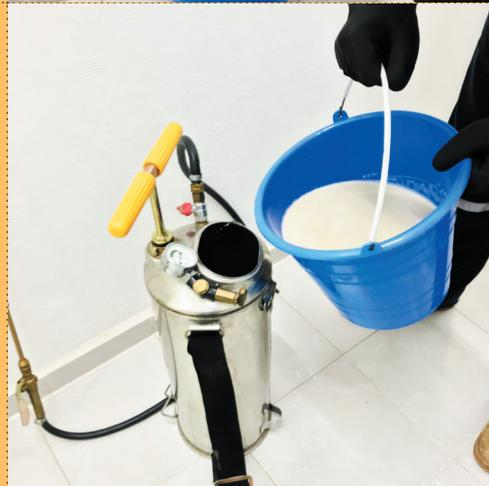
9. Com outros 1,5 litros de água, enxágue três vezes o recipiente onde a mistura foi preparada e deposite a água de cada enxágue no tanque do aspersor. A mistura final terá um volume de 7,5 litros. O equipamento deverá ter uma capacidade de 10 a 12 litros.
