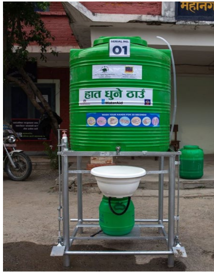
لشكل 10: محطة غسل يدين تعمل بدواسة القدم مع خزان ضخم. حقوق الصورة: منظمة WaterAid، نيبال
