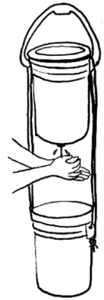
الشكل 8: حنفية Tap Up - مغسلة بدلوين. حقوق الصورة: Lippincott (2011), CERN Open Hardware Licence
