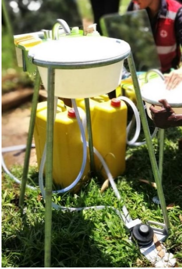
الشكل 19: حنفية Jengu متصلة بعلب مملوءة بالماء؛ تعديلات جهاز Jengu لغسل اليدين (من اليسار إلى اليمين: للأشخاص الذين يعانون صعوبة في الحركة، والأطفال والبالغين) حقوق الصورة: جي روز، الصليب الأحمر البريطاني؛ Arup
