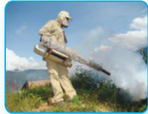
*Fumigación con niebla caliente termonebulizador con máquinas swinfor*
