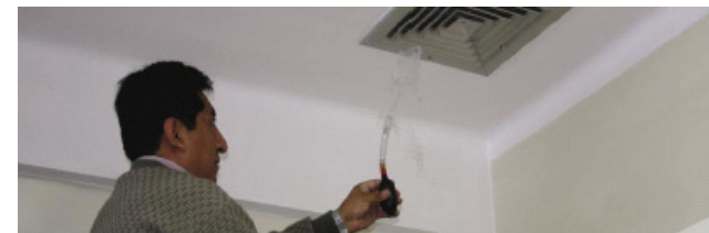
Se debe comprobar el flujo del aire con tubos de humo
