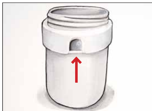
Las lengüetas están a cada lado de las cubetas de la centrífuga
