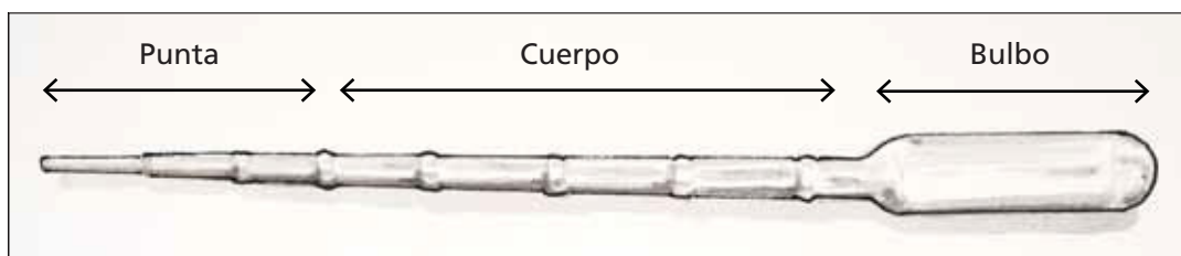
Estructuras básicas de una pipeta desechable
