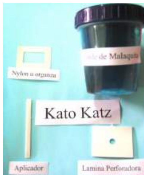
Figura 11. Materiales del método de Kato - Katz: lámina perforada, aplicador, nylon u organza y verde de malaquita
