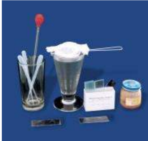
Figura 8. Materiales del método de Baermann: copa de vidrio, pipetas de transferencia, coladera, láminas y laminillas
