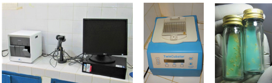
Figura 2.2 Xpert, incubadora de LPA y cultivo en medio sólido con colonias de bacilos
