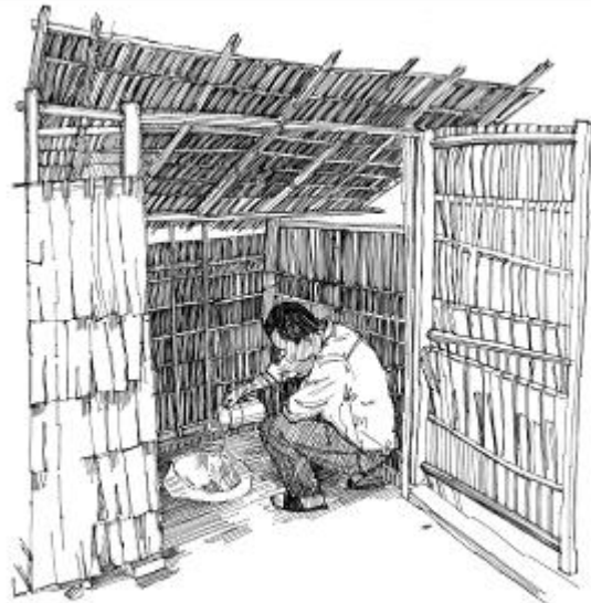
Pour flush latrine (Credit: Shaw, WEDC)
