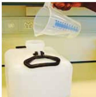
4. Ajouter l'eau distillée ou l'eau bouillie refroidie jusqu'au repère gradué indiquant 10 litres.
