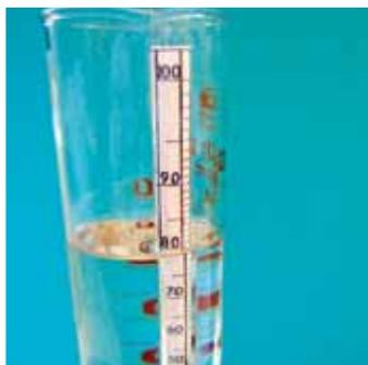
2. Les contrôles des produits finis sont obligatoires lorsque de l'éthanol ou une solution d'isopropanol sont utilisés. Contrôler la concentration finale de la solution à l'aide d'un alcoomètre. Les limites d'acceptabilité sont égales à  $\pm 5\%$  de la concentration finale (75-85% pour l'éthanol).
