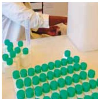
7. Répartir immédiatement la préparation dans les flacons de distribution (100 ml ou 500 ml). Placer les flacons remplis en quarantaine pendant 72 heures, délai permettant la destruction des spores bactériennes potentiellement présentes dans l'alcool ou dans les flacons (neufs ou réutilisés).
