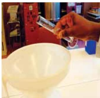
3. Ajouter le glycérol en utilisant un cylindre gradué. Le glycérol étant une substance visqueuse adhérent aux parois, rincer le cylindre avec un peu d'eau distillée ou d'eau bouillie refroidie, et verser le contenu dans la bouteille, le réservoir ou le récipient servant au mélange.
