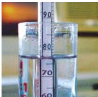
3. L'alcoomètre présenté dans ce document est utilisé pour mesurer la concentration en éthanol. S'il devait être utilisé pour mesurer la concentration en isopropanol, une solution à 75% indiquera 77% ( $\pm 1\%$ ) sur l'échelle, à une température de 25°C.
