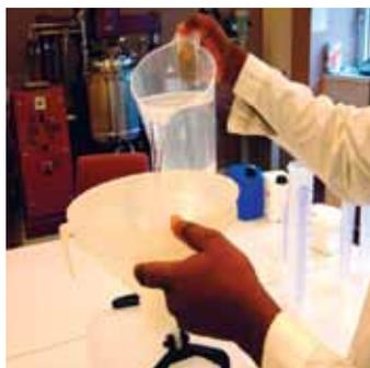
1. Verser la quantité d'alcool nécessaire à la préparation du produit dans la bouteille, le réservoir ou le récipient servant au mélange, en utilisant un bécher ou berlin gradué.
