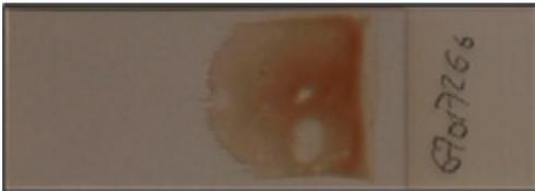
Figure 6 : Lames mal dégraissées, sales et poussiéreuses
