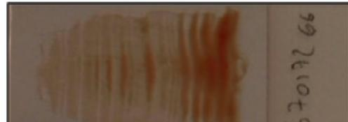
Figure 7 : Irrégularité du mouvement de tirage
