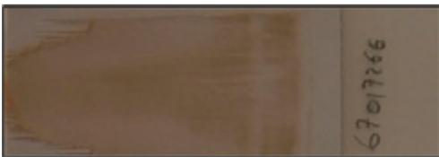
Figure 8 : Angle formé par la lame de tirage trop aigu
