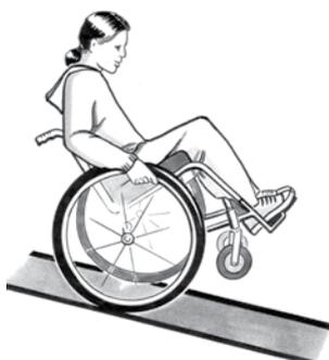
Si on déplace les roues arrière vers **l'avant**, le fauteuil roulant est plus facile à propulser en deux-roues.
