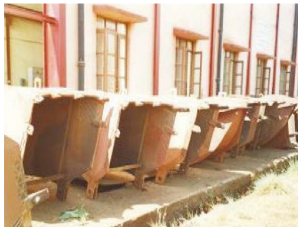
Figure 35. Godets d'élevateurs de minerai entreposés à l'envers © Ashwani Kumar
