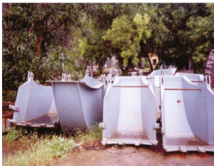
Figure 34. Godets d'élevateurs de minerai où de l'eau s'accumule © Ashwani Kumar
