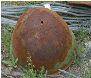
الصورة 1.12: قذيفة كروية 77 مم X 229 مم، إيسن/المانيا 1906 - صنعت للقوات التركية؛ كوسوفو. صورة من UNMAS / توماس إنكه
