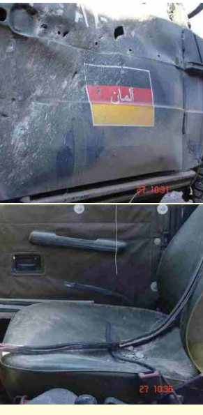
الصورة أ 2.1: فعالية البطانية الخاصة بالمقذوفات داخل باب السيارة وخارجه. لا توجد أية شظايا في الجزء الداخلي من الباب؛ أفغانستان. صورة / القوات الألمانية
