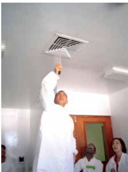
Foto 7: Realización de la prueba de humos en el inyector de aire del Laboratorio de Referencia Nacional de Guyana.
