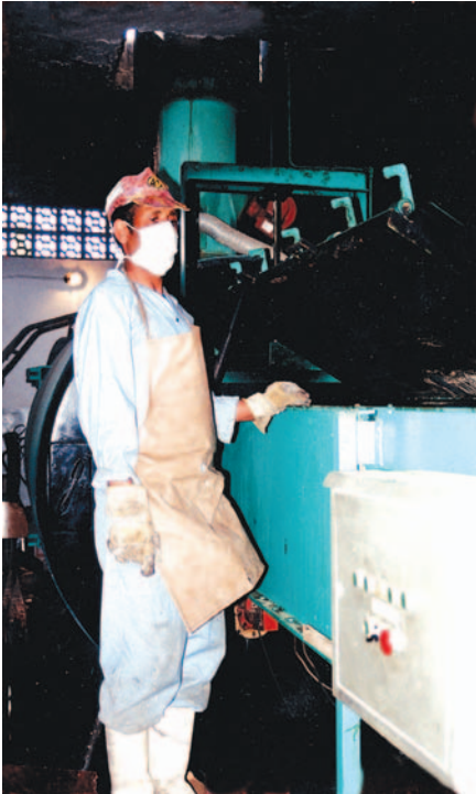
Figure 11. Les vêtements de protection d'un ouvrier responsable du chargement des sacs de déchets dans le dispositif d'alimentation de l'incinérateur
