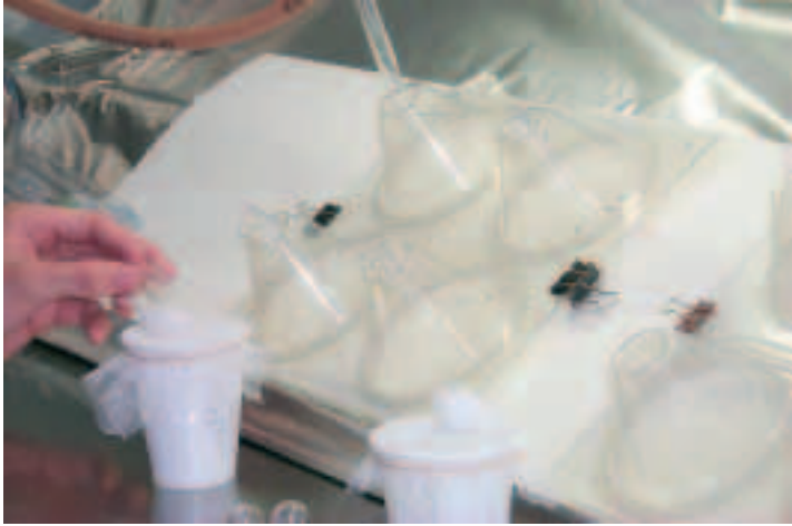
Figure 1. Cone bioassay on mosquito nets (courtesy of Dr Vincent Corbel, Institut de Recherche pour le Développement (IRD), Montpellier, France).
